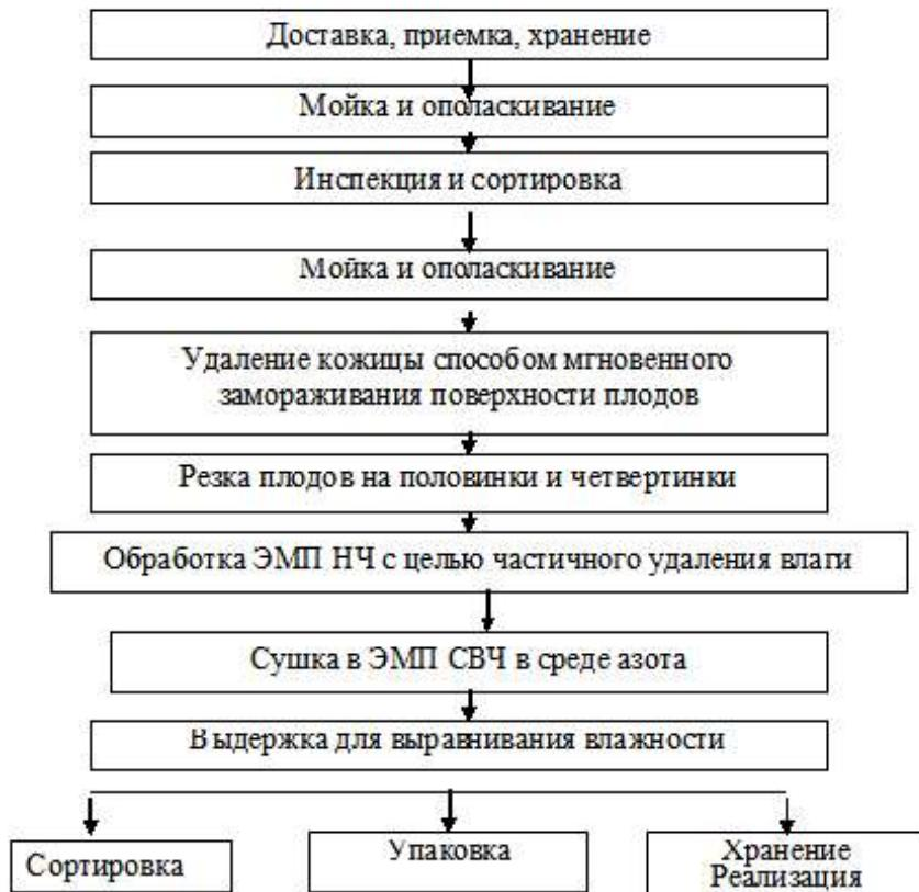
Рисунок 7 –Структурная схема производства сушёных томатов
